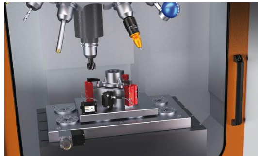
Bild Nr. 89-03 AM_FunksensorikMaschine.jpg Die neue AMF Funksensorik ist in der Werkstück- und Spannmittelabfrage vielseitig einsetzbar.
